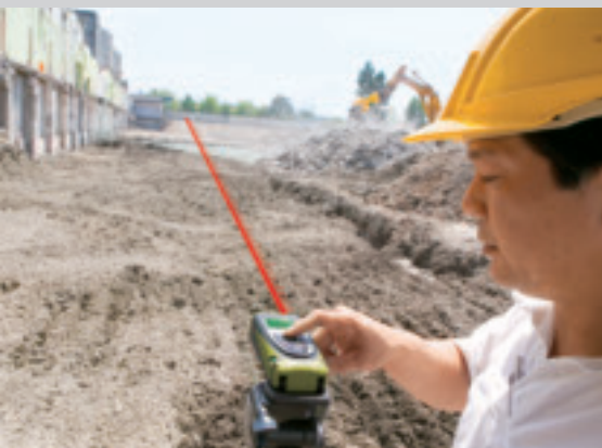
在数码瞄准器的帮助下实现强光下的远距离测量。
