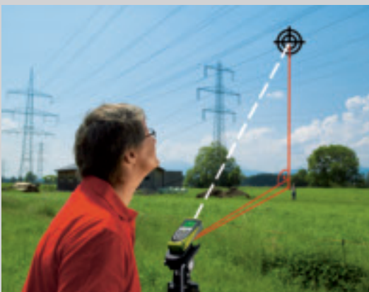
通过使用倾角传感器和数码瞄准器可进行间接的高度测量，高度可在首次测量时确定，甚至不必反射激光束。
